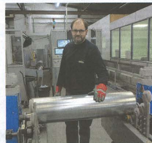
Le dernier investissement est une ligne automatisée de production de tuyaux soudés laser.
