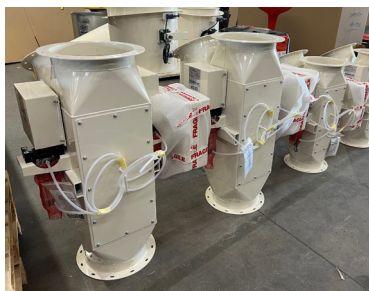
By-pass pneumatiques à double verin (DEBCP).
