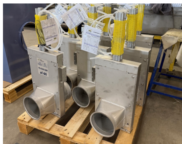
Registres « guillotines » à commande pneumatique (CDRRP).
