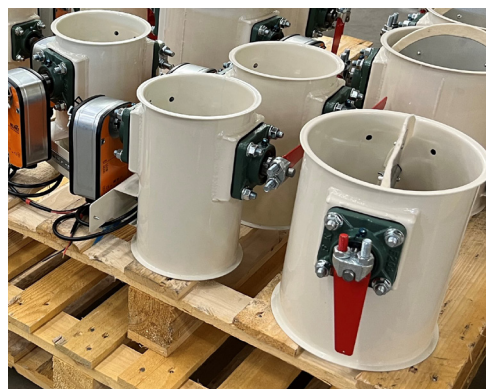
Des vannes « papillon » électriques (CDVRE) équipées d'un indicateur de volet.
