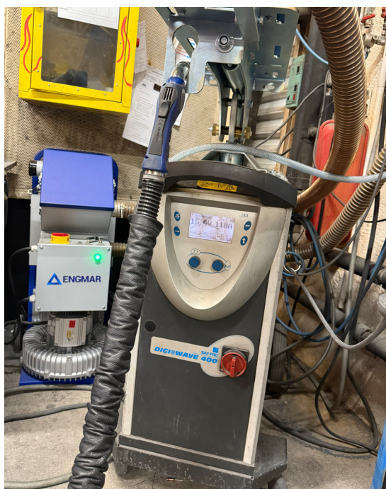
L'installation ENGIMAR et sa torche aspirante.
